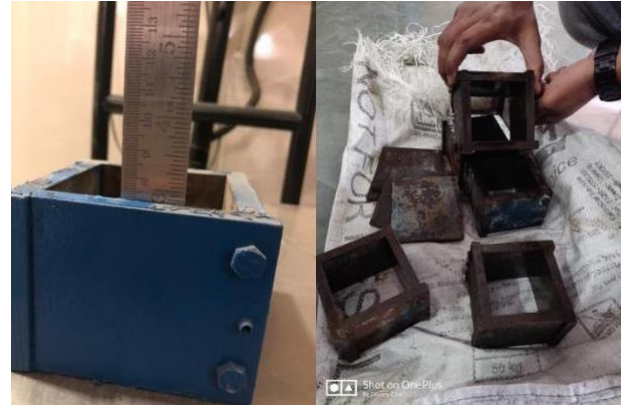
FIGURE NO:1.3. 70.6 x 70.6 x 70.6 mm Cubes Moulds.
