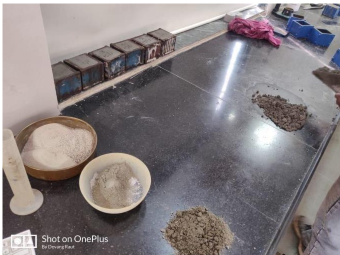
FIGURE NO:2.1.Cubes Casting.
